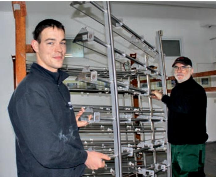
Markus Wurzbacher an seinem Arbeitsplatz: Gestelle für die Lackierung von Fahrzeugteilen, werden mit Säure und Lauge gereinigt.
